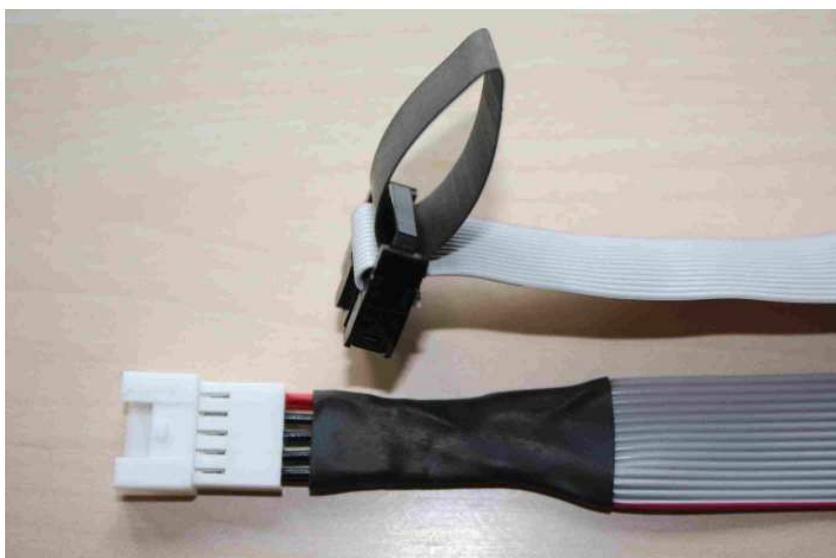
Der 21mm breite Schrumpfschlauch kommt als Schutz über die verlöteten Adern
